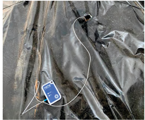
Figura 45: sensore monitoraggio temperatura e umidità
